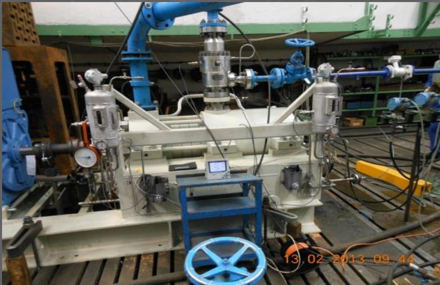
Čerpací soustrojí KDX3 - VT havarijní doplňovací čerpadlo (kys. boritá)
