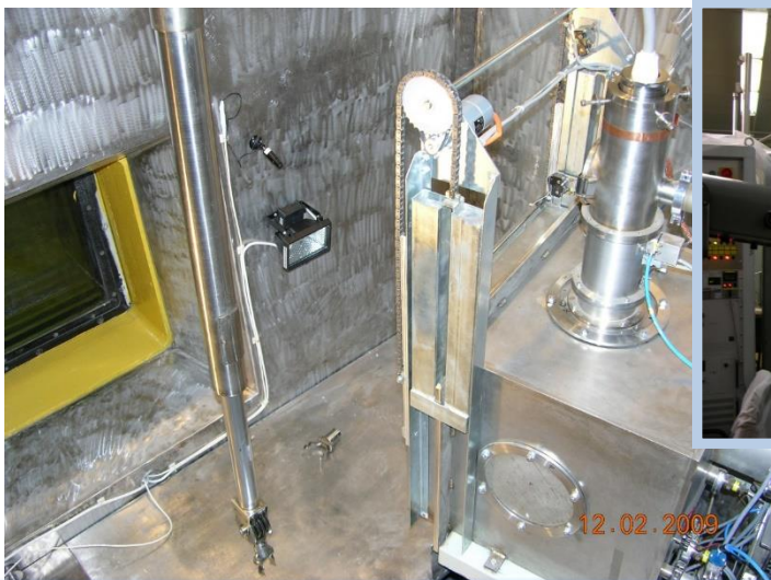
Электронно-лучевая установка для сваривания половинок образцов-свидетелей
